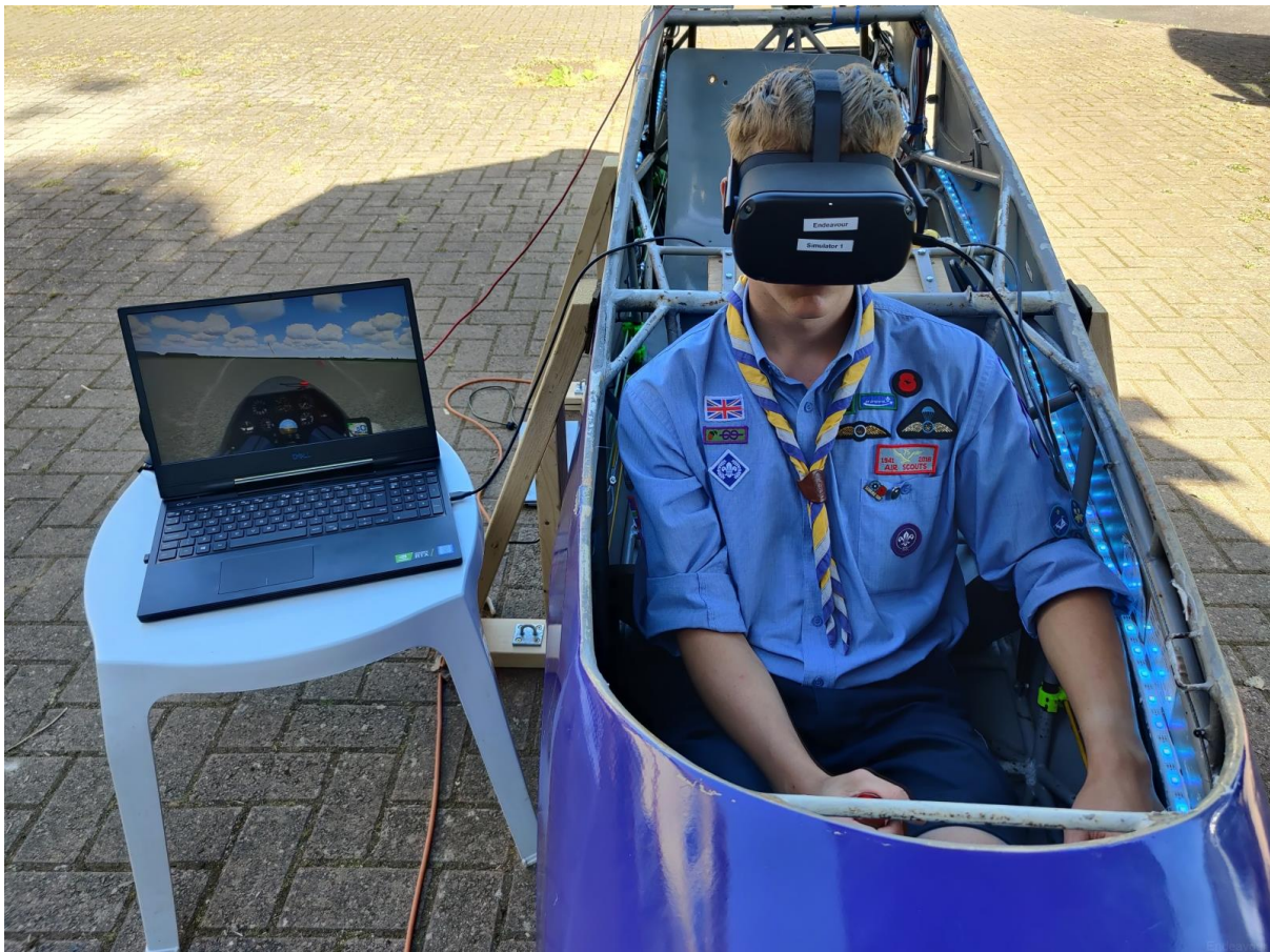
Super simpele K13 zweefvliegsimulator, kan mooier...
